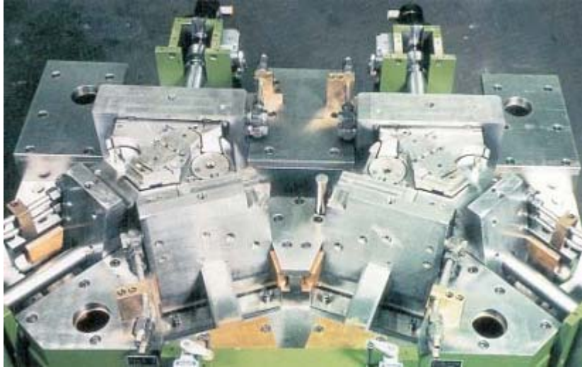
Fotoğrafta; binek otomobilinin havalandırma sistemine ait parçaların üretimi için, plastik kalıp çeliği ile imal edilmiş çeşitli kalıplar görülmektedir.
