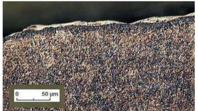
Bakır elektrot ile erozyon sonrası yüzey bitirme işlemi
