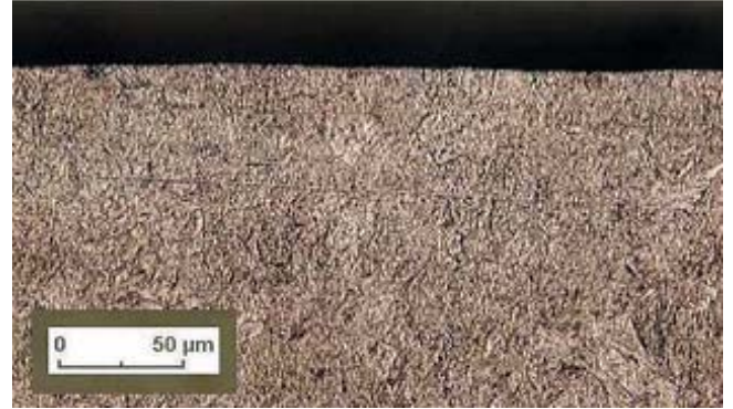
Sert Metal (Karbür) takımlarla frezeleme sonrası yüzey bitirme işlemi
